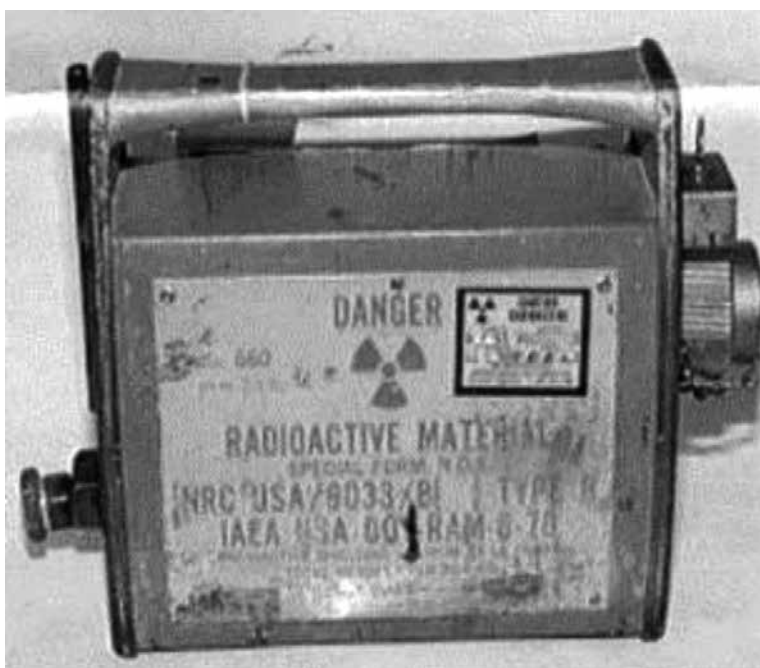
SLIKA 7. Tipična radiografska kamera.
