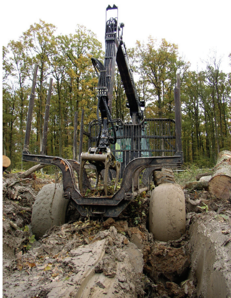
Slika 7. Ekološki, estetski, energijski i ekonomski (imobilizacija vozila) neprihvatljiv kolotrag na slabonosivom tlu
