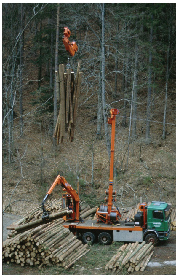
Slika 53. Tijek tehnološkog procesa – sortimentna metoda (žičara s dizalicom i hvatalom)
