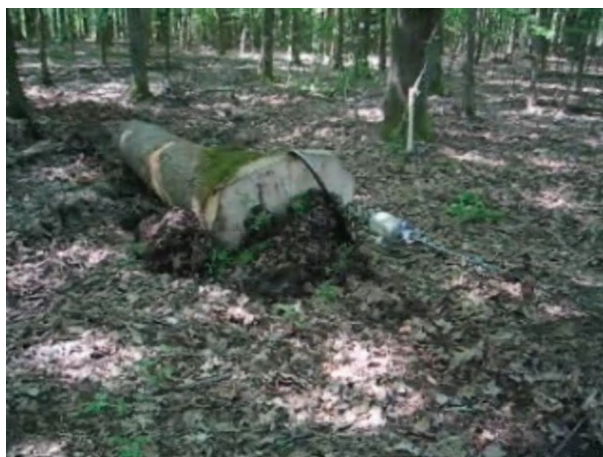
Slika 3. Djelovanje čela trupca pri vuči po tlu
