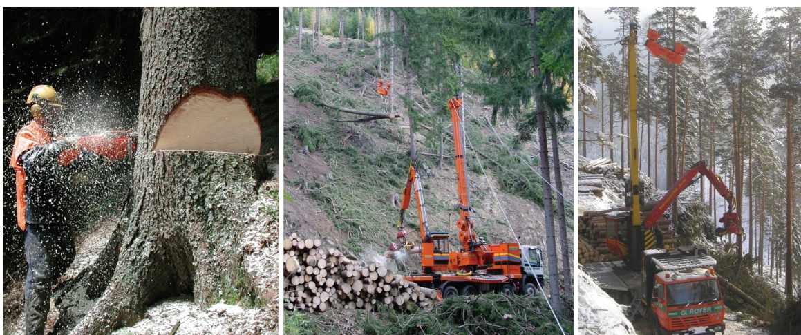
Slika 52. Tijek tehnološkog procesa – stablovna metoda izradbe drva (žičara s dizalicom i glavom za izradbu drva)
