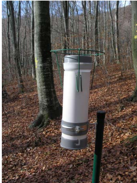
Slika 9. Bulk za mjerenje količine padalina i uzorkovanje na plohi
