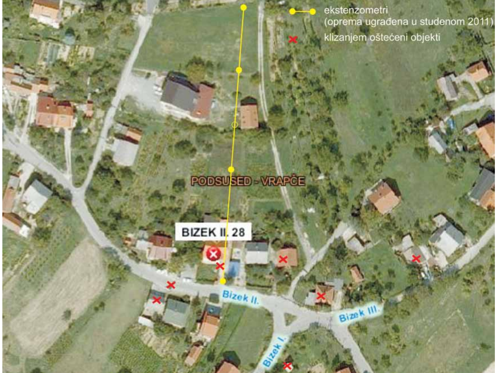
▲ PRIKAZ 20, POLOŽAJ EKSTENZOMETARA (ŽUTA LINIJA) KOJI SU UGRAĐENI U STUDENOME 2011. S OZNAKAMA OŠTEĆENIH OBJEKATA ZBOG KLIZANJA / IMAGE 20
