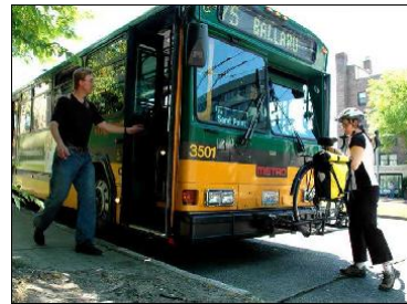
Nosač za bicikle na prednjem kraju autobusa u Sjedinjenim državama – u Europi ovo nije dopušteno
