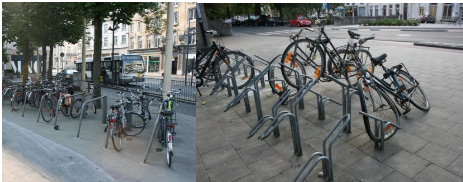
Preporučeni stalci u obliku slova "U" i stalci u obliku spajalice koje treba izbjegavati – foto: T. Asperges
