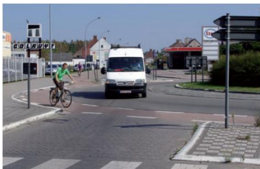
Opasnosti biciklističke trake na kružnom toku (izvor: Vademecum fietsvoorzieningen – Brussels)
