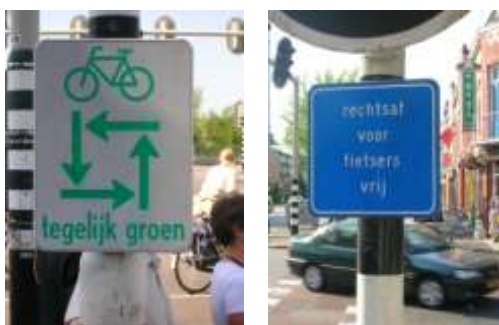
Zeleno svjetlo biciklistima za sve smjerove; biciklistima uvijek dozvoljeno skretanje udesno (foto izvor: T. Asperges)
