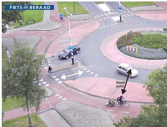
Jednotračni kružni tok s biciklističkom stazom, s prednošću prolaza za bicikliste (Enschede, NL). Obratite pažnju na pravilan kružni oblik toka i obojene biciklističke prijelaze.
