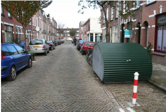
„Bubanji“ za bicikle postavljen na parkirnoj traci u stambenoj zoni; stupić ograničava pristup. Utrecht, NL 2
