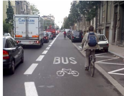
Uska autobusno-biciklistička traka pomaže zaobići prometni čep; otvoren profil s oznakama bicikla na kolniku (D. Dufour)
