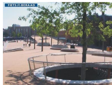
Intermodalna biciklistička stanica u Groningenu; podzemna, ali dobro osvijetljena danjim svjetlom i opremljena prilazima malog nagiba (izvor: Fietsberaad – NL)
