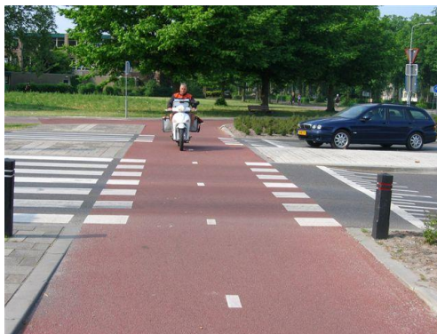
Dvosmjerna biciklistička traka s prednošću prolaza i prometnim otokom (foto izvor: P. Kroeze)
