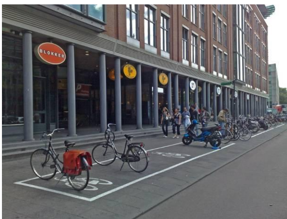
Rezervirane površine za parkiranje bicikala, obilježene samo oznakama na tlu. Ovime se izbjegava neuredno parkiranje i zbrka. (Amsterdam, NL)
